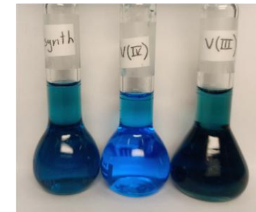
Eri hapetusasteilla olevia elektrolyyttiliuoksia (Vasemmalta vanadiinin hapetusluvut 3.5, 4 ja 3).
